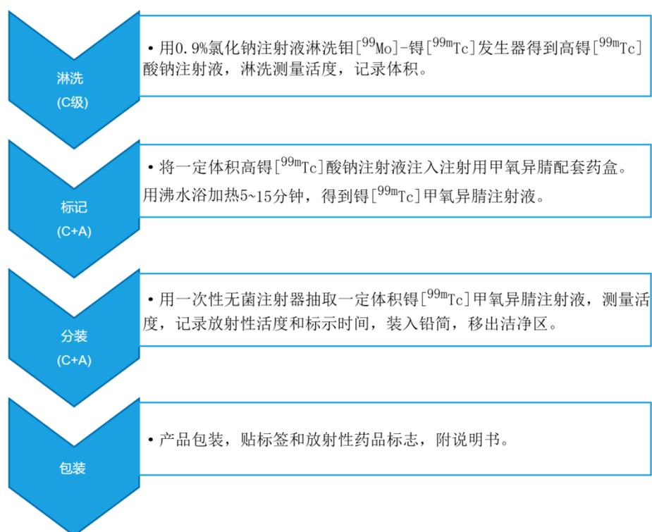
图 4. 锝<sup>[99mTc]</sup>甲氧异腓注射液生产工艺流程图 (示例)
