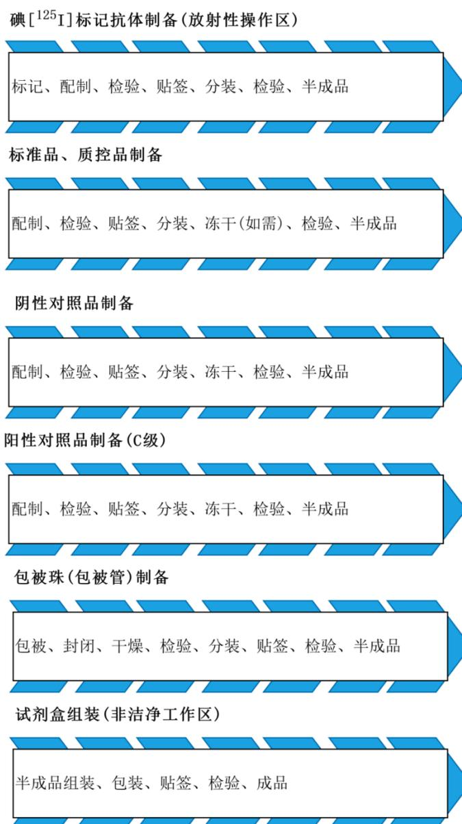
图 10. 免疫放射分析法试剂盒生产工艺流程图（示例）
